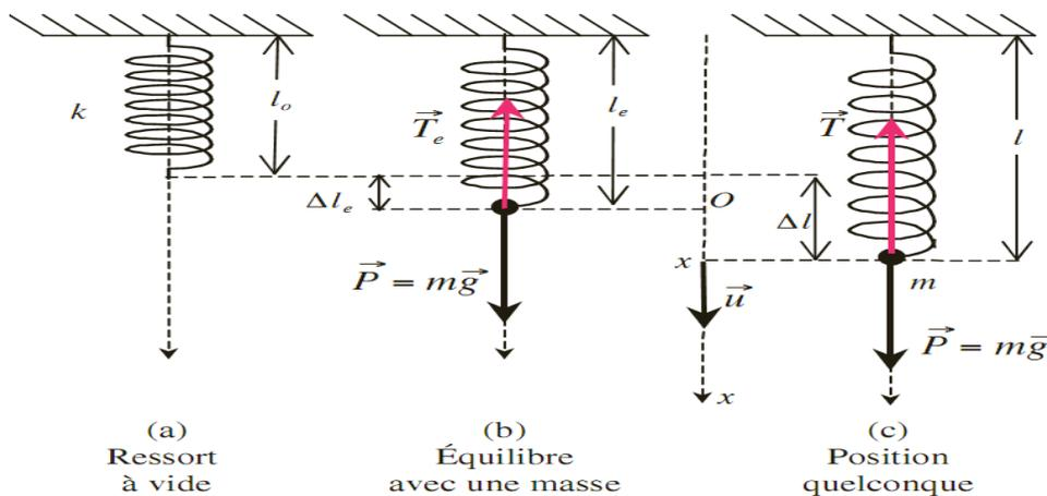
Le système constitué de la masse  $m$  est étudié dans le référentiel terrestre galiléen. Il y a deux forces extérieures agissant sur le système : le poids  $\vec{P} = m\vec{g}$  et la tension  $\vec{T}$  du ressort. Avec un axe vertical orienté vers le bas et un vecteur unitaire  $\vec{u}$ , on peut écrire :
