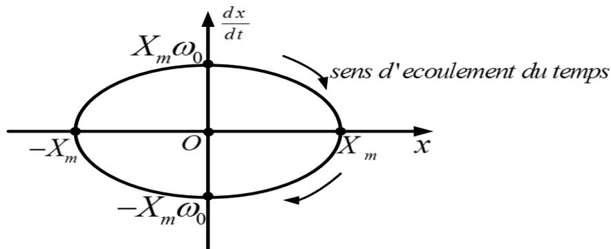
Lorsque  $t$  augmente,  $x(t)$  augmente vers sa valeur maximale  $X_m$  et  $\frac{dx(t)}{dt}$  diminue vers 0.
